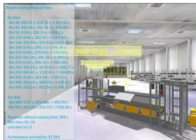
Abbildung 4. Berechnung der Leistungsverfügbarkeit auf Basis von Laufzeiten.
