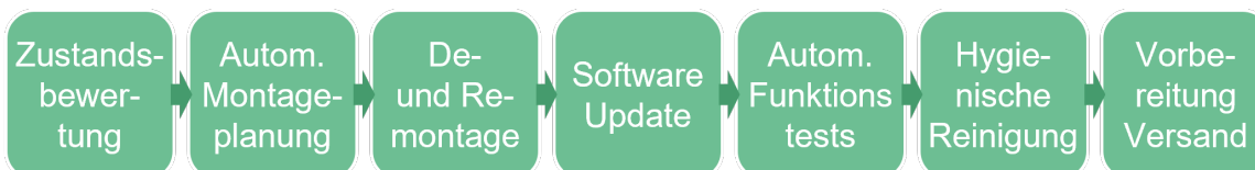
Abbildung 6: Vorgesehene Refurbishment Prozesskette für die Second-Life Waschmaschine (Quelle: Miele)
