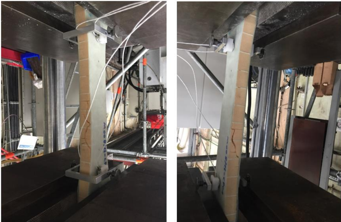
Abbildung 2: Zug-Druck-Versuch zum Zeitpunkt des Strukturversagens - Probe CP01
