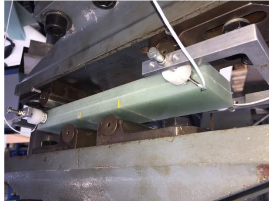
Nach dem Strukturversagen (weiße Trennschicht in der Mitte)
