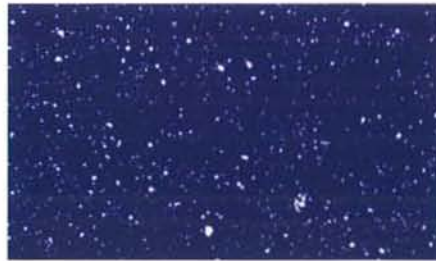
Bild 6: Verteilung der Partikel auf Substratoberfläche bei Betrachtung mit dem Messgerät PartSens
