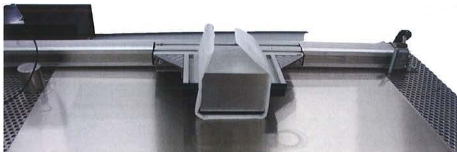
Bild 3: gleitende Fixierung des Reinraumtuches mittels Auflagegewicht
