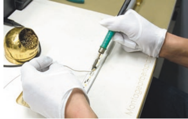
Abb. 10.3 Manueller Lötprozess von LED-Leuchtbreite
