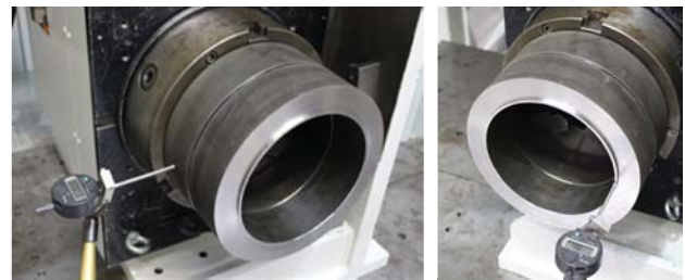
Bild 5: Einspannverhältnisse der Rohrabschnitte
