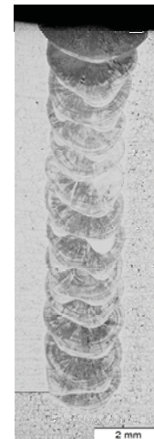
Bild 6: Querschliff einer 12,5\ \text{mm} tiefen Schweißnaht
