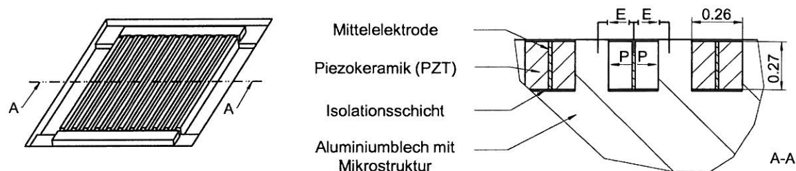
Abb. 1: Aufbau des Piezo-Metall-Sensor Moduls
