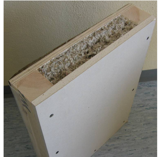
Bild 8: Fotografische Aufnahme der Bekleidungs-elemente mit Zellulosefaserdämmung.
