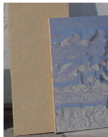
Bild 10: Fotografische Aufnahme der Weichfaserplatten mit dampfdicht versiegelter Rückseite.
