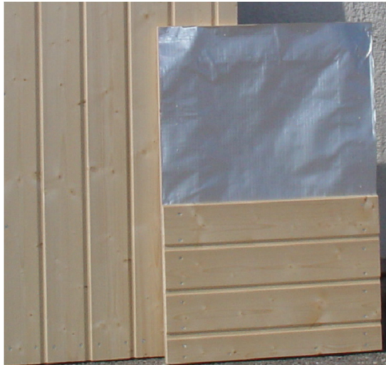
Bild 6: Fotografische Aufnahme der Bekleidungs-elemente aus Nut- und Federbrettern.
