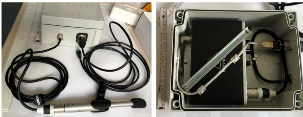
Abbildung 13: Foto der mobilen Audiobox; Links : Außenansicht. Rechts : Innenansicht.
