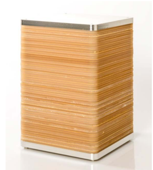
Demonstrator eines Batteriestacks auf Basis der Zink-Ionen-Technologie
