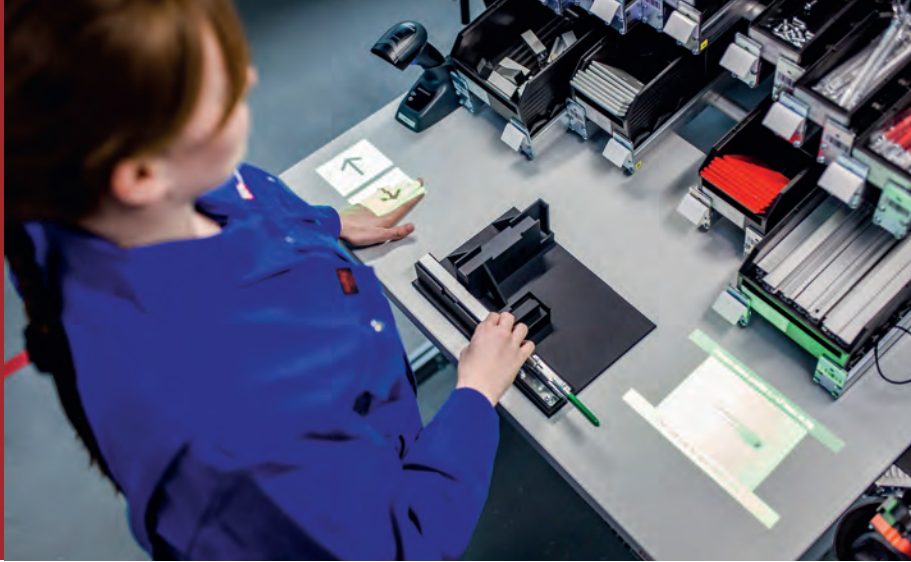
Abbildung 10: Visualisierung von Montageanweisungen als Bildprojektionen auf der Tischplatte
