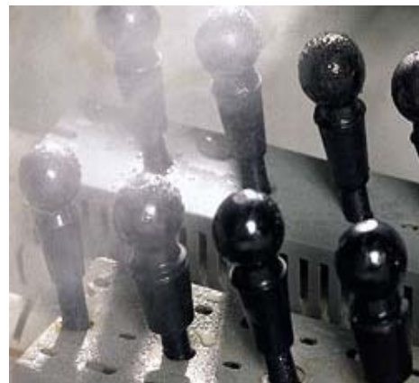
Abb. 1 Kugelzapfen im Salzsprühnebeltest
