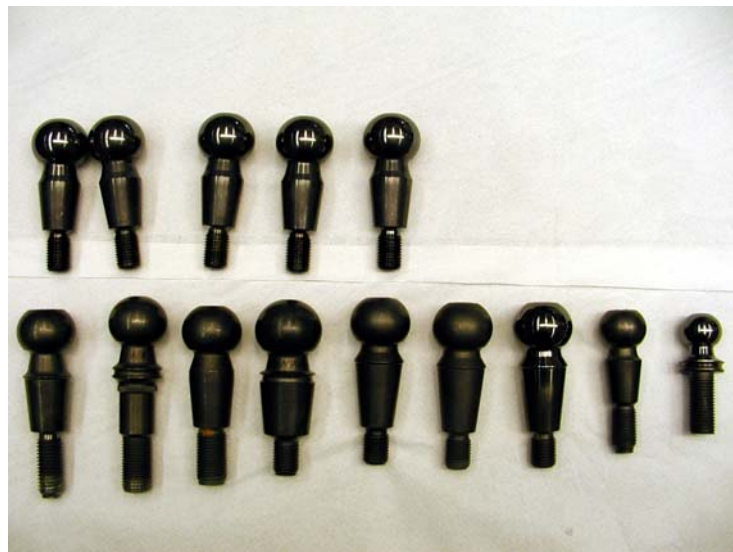
Abb. 6 Zweiter Probensatz. Bestehend aus: 5 i.O. Teilen (oben) und 9 n.i.O. Teilen verschiedener Geometrien (unten)
