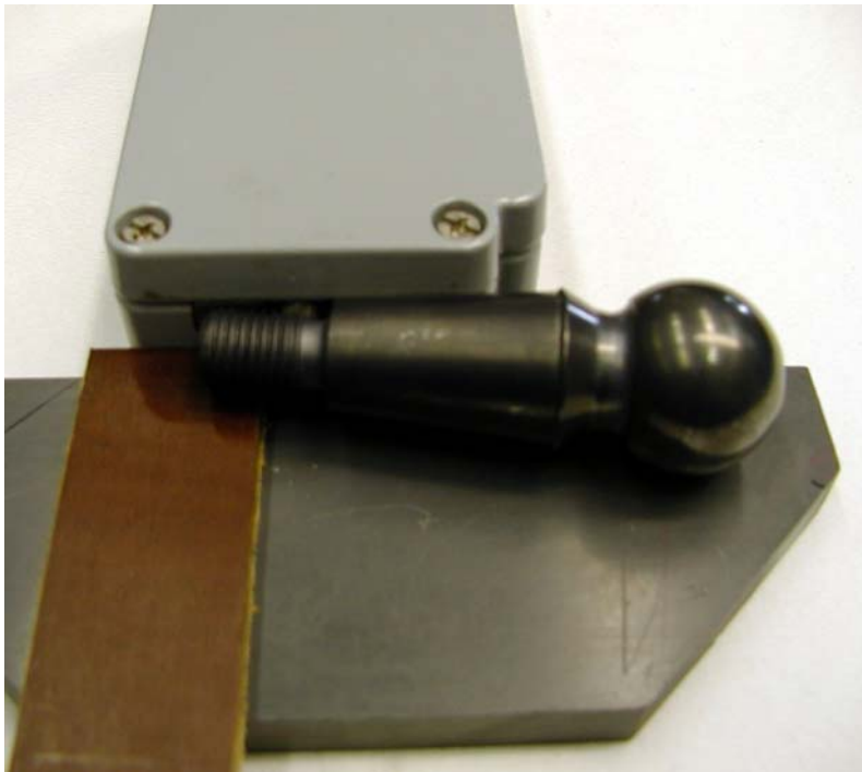
Abb. 17 Miniaturisiertes 3MA-System mit Probe auf Probenunterlage zur Stabilisierung der Probenlage
