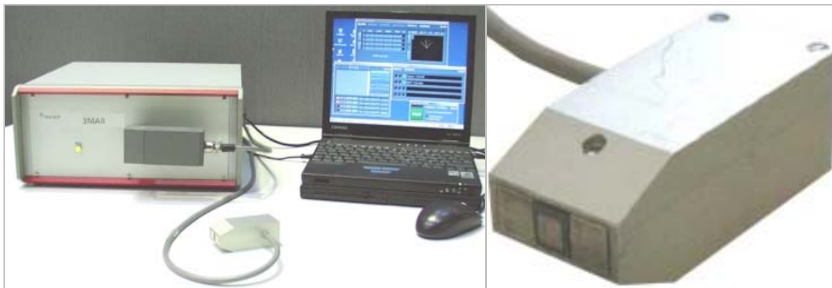
Abb. 13 links: aktuelles 3MA-Gerät in 19" Gehäuse mit Laptop zur Auswertung rechts: Standardsensor des 3MA-Geräts mit beweglichem Sensorelement und überstehenden Polschuhen
