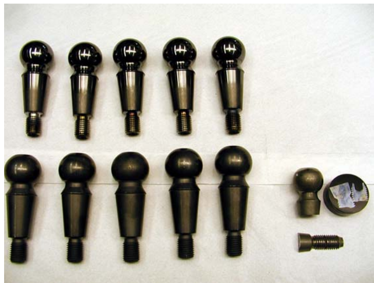
Abb. 5 Erster Probensatz. Bestehend aus: 5 i.O. Teilen (oben), 5 n.i.O. Teilen mit Verbindungsschicht (unten) und 1 n.i.O. Teil mit Diffusionsschicht (unten rechts)
