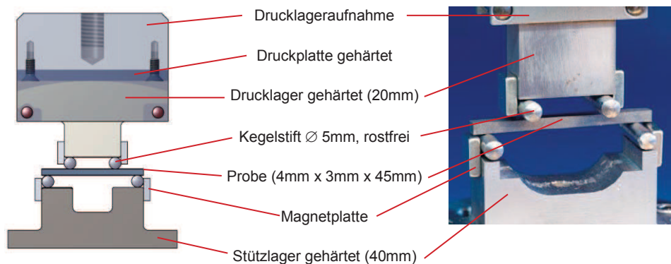
Bild 2: Verwendeter Versuchsaufbau Figure 2: Experimental setup
