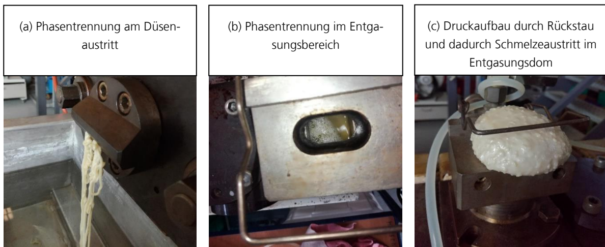
Abb. 4: Zusammenstellung unterschiedlicher Verarbeitungsprobleme: Phasentrennung am Düsenaustritt (a), Phasentrennung im Entgasungsbereich (b) und Druckaufbau durch Rückstau und dadurch Schmelzeaustritt im Entgasungsdom (c).
