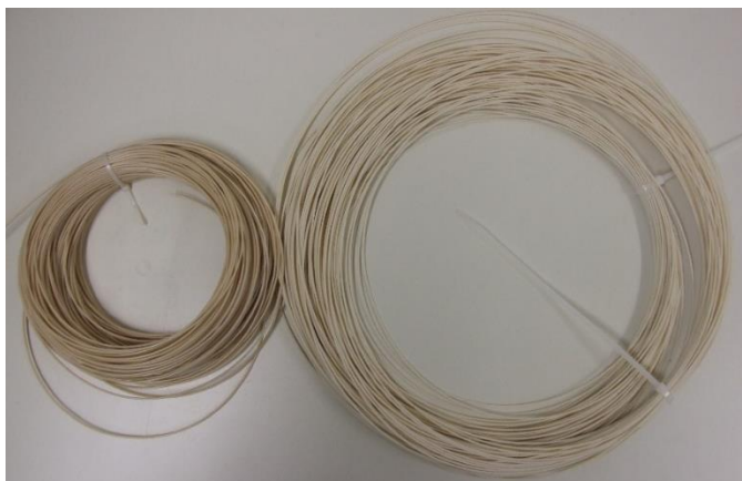
Abb. 9: Mittels Haake Rheocord 90 hergestellte PHB(V)-Filamente mit NA (links) und PHB(V)-Filamente modifiziert mit NA und BMP (rechts)
