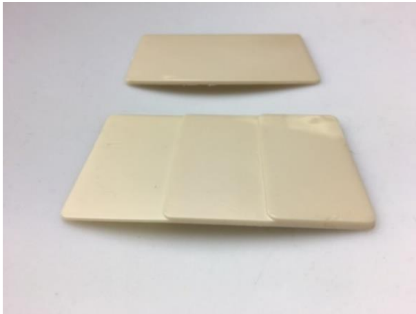
Abb. 15: BMP- und VX-modifizierte PHB(V) Platten, hergestellt im Spritzgießprozess
