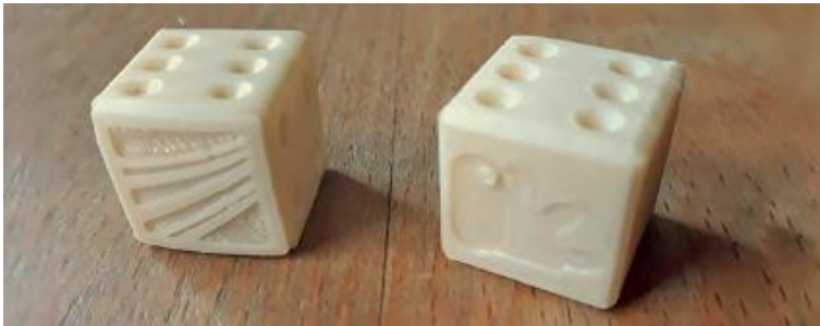
Abb. 14: Gedruckte Würfel aus BMP-modifiziertem PHB(V)
