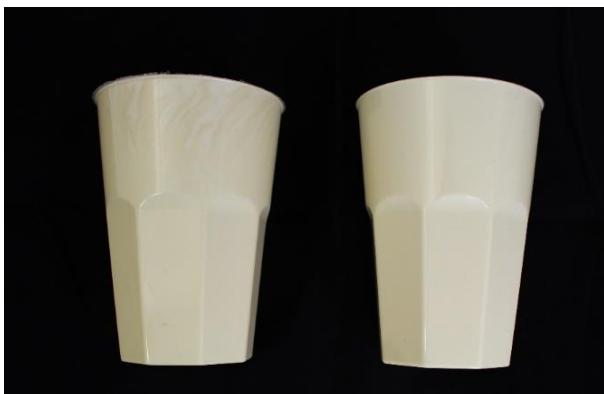
Abb. 17: BMP- und VX-modifizierter PHB(V) Getränkebecher (Spritzgießen)
