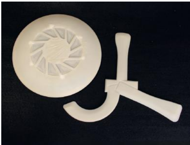
Abb. 16: BMP- und VX-modifiziertes PHB(V) Frisbee und Bumerang (Spritzgießen)
