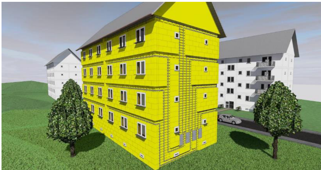
Abbildung 11 – Lüftungsgeräte und fassadennintegrierte Leitungen in Mineralwolle, vor Einbau der Mineralwolle-Deckplatte, Projekt FIHLS (Rohrer 2018).
