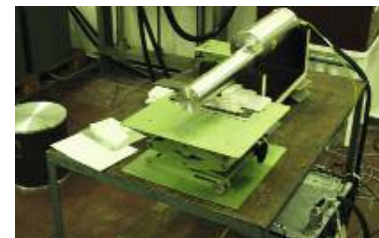
Abb. 3: Testmessung mit dem kleinen, mobilen Neutronengenerator GENIE16C: Der Neutronengenerator besteht aus der metallischen Neutronenröhre und dem Steuerkoffer (unter dem Tisch). Dieser wird von einem abgesetzten Laptop ferngesteuert
