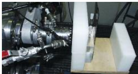
Abb. 2: Untersuchungen am Neutronengenerator SAMES zur Neutronenradiographie: Ein Objekt aus Plastik mit Glasröhrrchen wird mit Neutronen durchstrahlt und dahinter eine Dysprosium-Folie aktiviert. Dann wird die Folie auf einer Bildplatte autoradiographiert. Die Bildplatte wird mit einem speziellen Scanner ausgelesen
