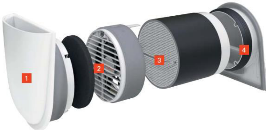
Abbildung 23 – Das installierte dezentrale Lüftungsgerät Vitovent 100D der Fa. Viessmann. 1 – Innenblende, 2 – Lüfter, 3 – Wärmespeicher, 4 – Außenblende. [Bild:Viessmann]
