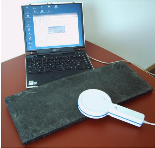
Bild 5 Fertiggestelltes Leichtbauteil mit integriertem Temperatursensor in der RFID-Testumgebung.
