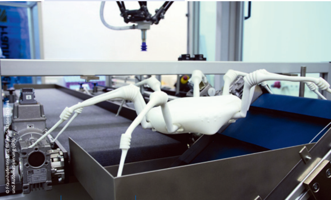
Die 3-D-gedruckte Roboterspinne bewegt ihre acht pneumatisch betriebenen Beine, kann sie beugen und strecken.
