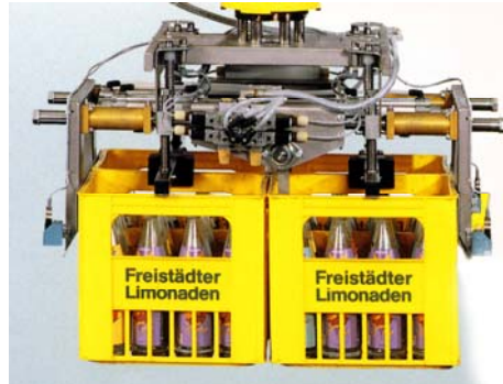
Abb. 7: Spezialgreifer für Getränkekästen [Quelle: KRONES AG, Neutraubling]
