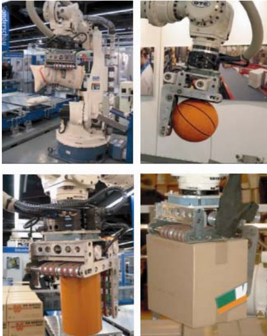
Abb. 29: Greifsystem Traction-Gripper im Einsatz mit Knickarmroboter beim Handling unterschiedlicher Objekte
