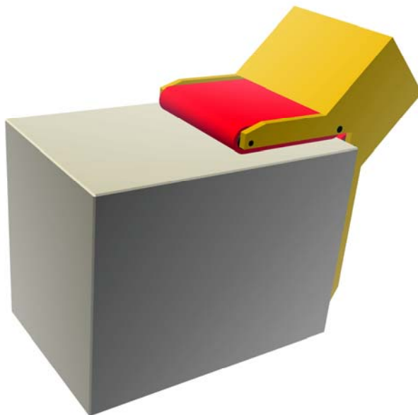
Abb. 12: Prinzipbild Traction-Gripper mit quaderförmigem Objekt
