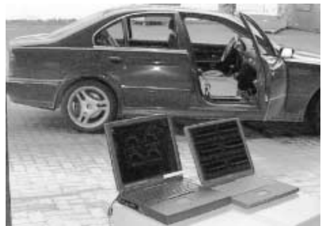
Abb. 2: Versuchsfahrzeug mit eingebautem System zur Bremsgeräuscherfassung sowie zwei mit dem System über Funk-LAN verbundene Auswerterechner.
