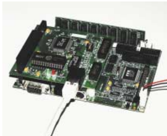
PC/104-Rechner mit Netzwerkkarte, Entwicklungs- und Zielplattform für einen intelligenten Datenlogger (Industrieprojekt, Deutz AG).
