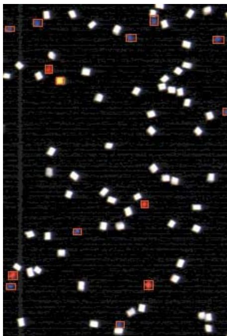
Abb. 1: Darstellung bei laufender Sortierung von Kunststoffgranulat. Die rot umrahmten Granulat Körner werden aussortiert.
