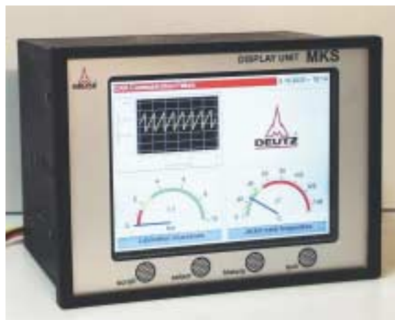
Beispiel eines Embedded Systems mit LC-Display (Auftraggeber: Deutz AG).
