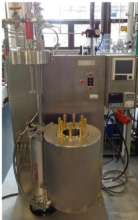
Abbildung 5: Verwendeter 2 Liter-Rührautoklav
