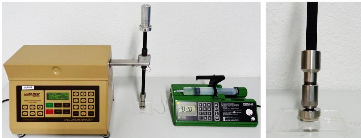
**Abbildung 7: Taber Abraser und Perfusor (links) und Detailaufnahme des am Taber Abraser befestigten Prüfkopfes auf der Probehalterung aufliegend (rechts)**
