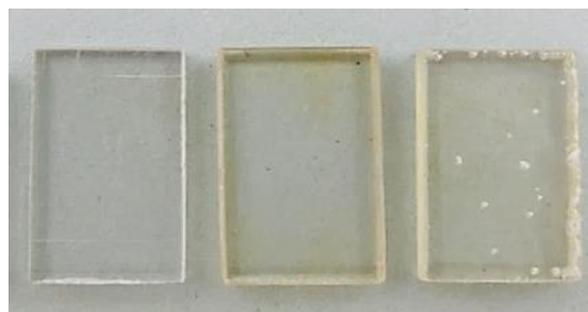
Abbildung 13: Bei 20 °C imprägniertes PC (linke Probe) und bei 80 °C imprägniertes PC (mittlere und rechte Probe)
