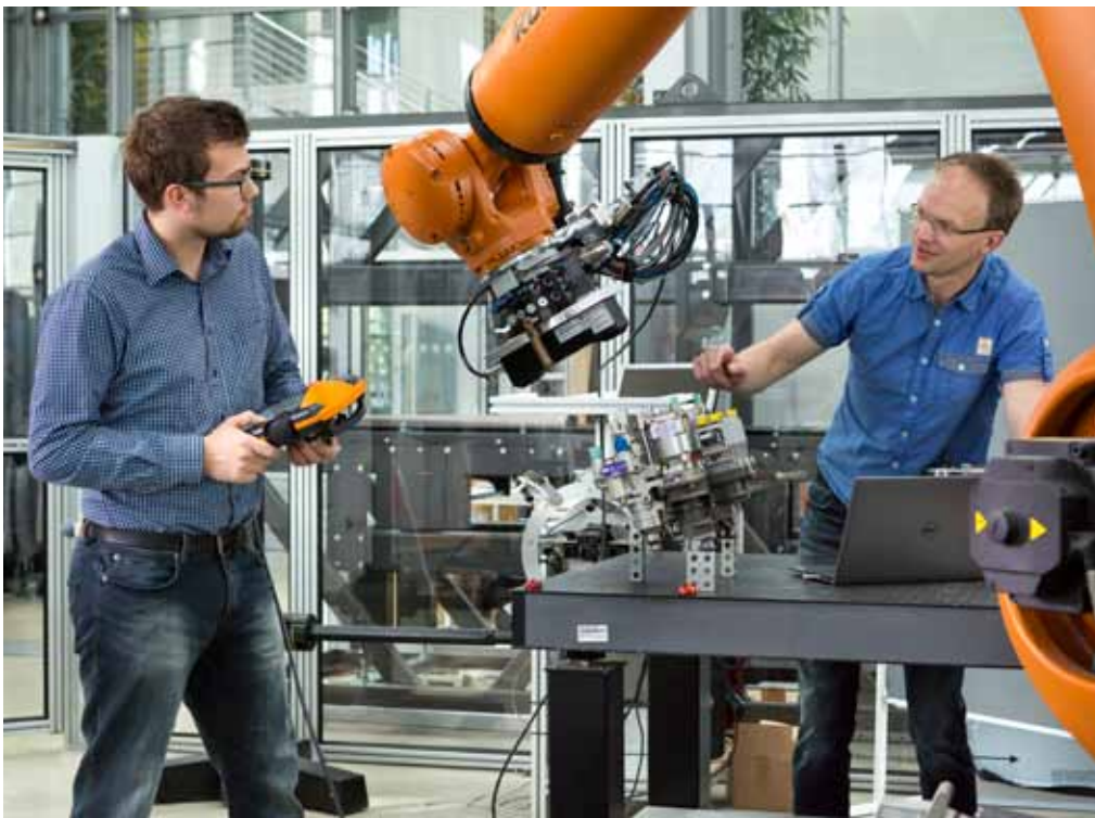
Forschungsingenieure am Fraunhofer IFF bei der Inbetriebnahme eines robotergeführten 3D-Sensors für die optische Montageprüfung. Foto: Fraunhofer IFF, Uwe Völkner
