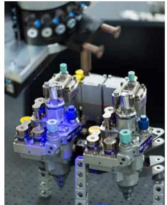
Optisches Vermessen einer Baugruppe, um die Korrektheit der Montage zu prüfen. Die realen Teile werden von der Software mit den digitalen Planungsdaten verglichen. Abweichungen werden sofort erkannt. Foto: Fraunhofer IFF, Uwe Völkner
