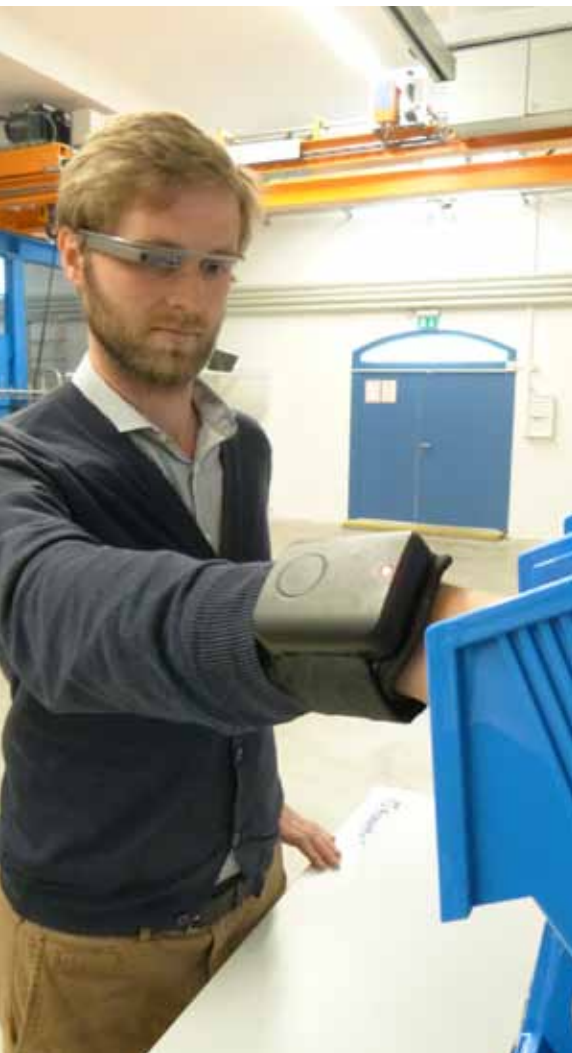
Test des integrierten Systems mit RFID-Armband und Smart Glasses. Foto: Fraunhofer IFF
