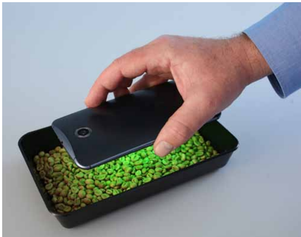
Für die Entwicklung des Prototyps der App HawkSpex® mobile arbeiteten die Forscher des Fraunhofer IFF mit verschiedenen Rohkaffee-Sorten. Die App erkennt genau, ob es sich z.B. um Arabica oder Robusta handelt. Foto: Fraunhofer IFF, Viktoria Kühne
