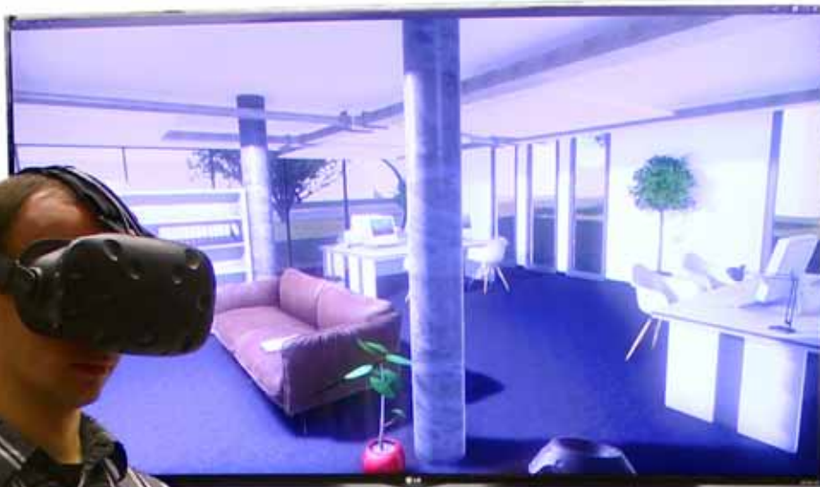
Das virtuell-interaktive Begehen von geplanten Bauprojekten vermittelt einen sehr realistischen Eindruck der künftigen Gebäude. Grundlage sind die 3D-Daten des Baus. Varianten und Änderungen können so vorab blitzschnell geprüft und bewertet werden. Foto: Fraunhofer IFF
