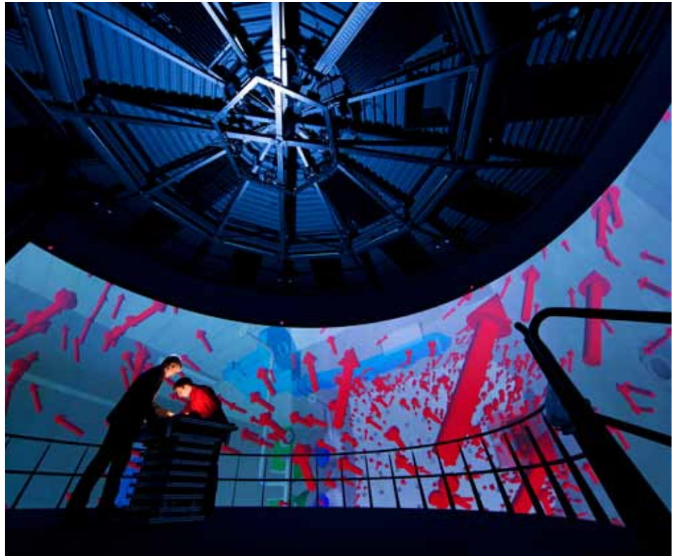
Der »alte« Elbe Dom gehört mit seiner 360-Grad-Projektionsfläche, einem Durchmesser von 16 Metern und einer Höhe von 6,5 Metern zu den größten Visualisierungssystemen für virtuell-interaktive Anwendungen für Wirtschaft und Forschung in Deutschland. Foto: Thomas Ernsting
