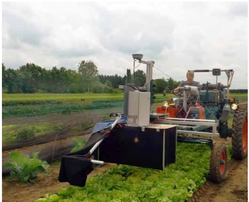
Künstliche Intelligenz benötigt umfangreiche, repräsentative Datensätze in digitaler Form. Deren Erhebung geschieht unter realitätsnahen Bedingungen, z.B. im klassischen Gemüseanbau. Hier erfassen Mitarbeiter des Fraunhofer IFF Kopfsalat mit hyperspektraler Kameratechnik. Foto: Fraunhofer IFF
