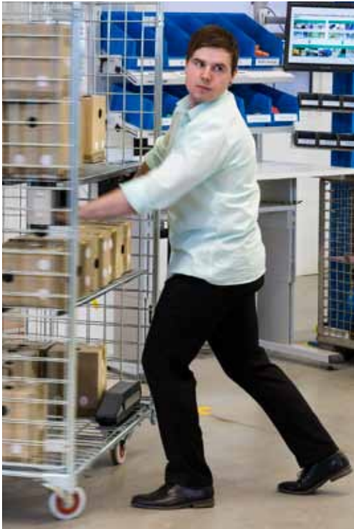
Dank der taktilen Servolenkung wird das Bewegen schwerer und unhandlicher Kommissionierwagen kinderleicht. Fotos: Fraunhofer IFF, Uwe Völkner
