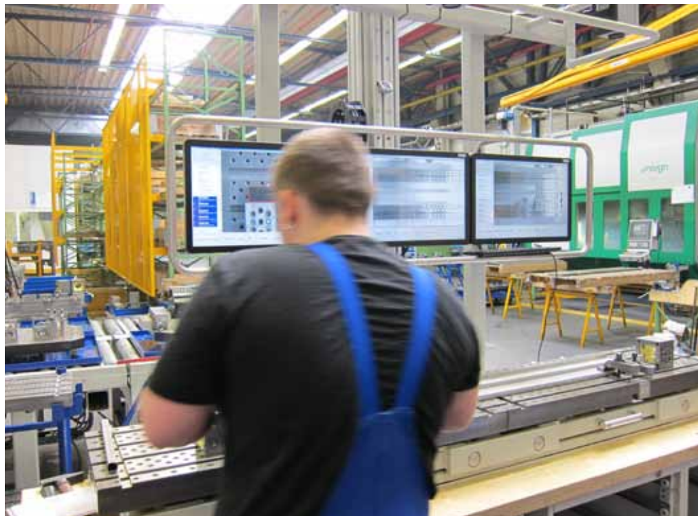
Ein »digitaler Assistent« unterstützt einen Werker bei der Montage von Bauteilen in eine komplexe Baugruppe, wie hier bei einem Schaltschrank. Über einen Bildschirm zeigt ihm das System genau an, wie das Bauteil zu montieren ist oder ob ein Montagefehler vorliegt. Foto: Kolbus GmbH & Co. KG
