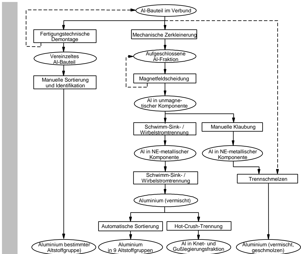
Bild 31: Prozessvarianten der Vorbehandlung zur Aluminiumverwertung
