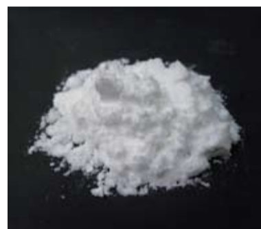
Abb. 3: Rückgewonnene Nährstoffsalze (MAP) als Produkt, das direkt als Dünger eingesetzt werden kann.
