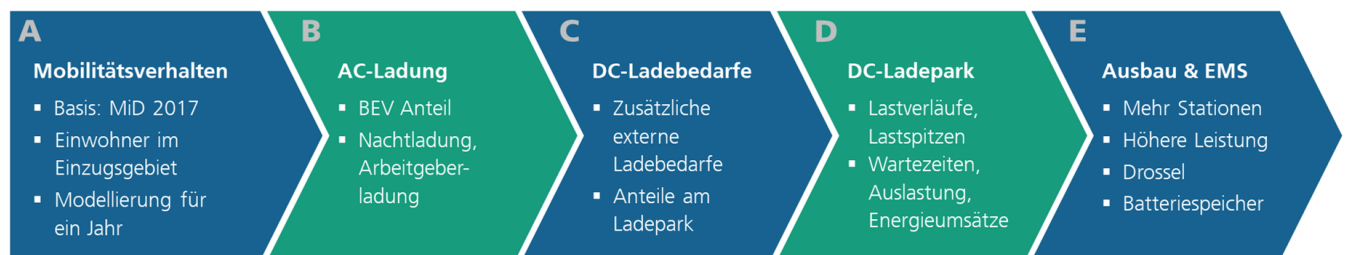
Abbildung 2-1: Die simulationsbasierte Potenzialanalyse für urbane DC-Ladeparks erfolgt in mehreren Teilschritten, von der Modellierung des Mobilitätsverhaltens der Bewohner im Einzugsgebiet bis zur Analyse der technischen Anforderungen an die Infrastruktur.
