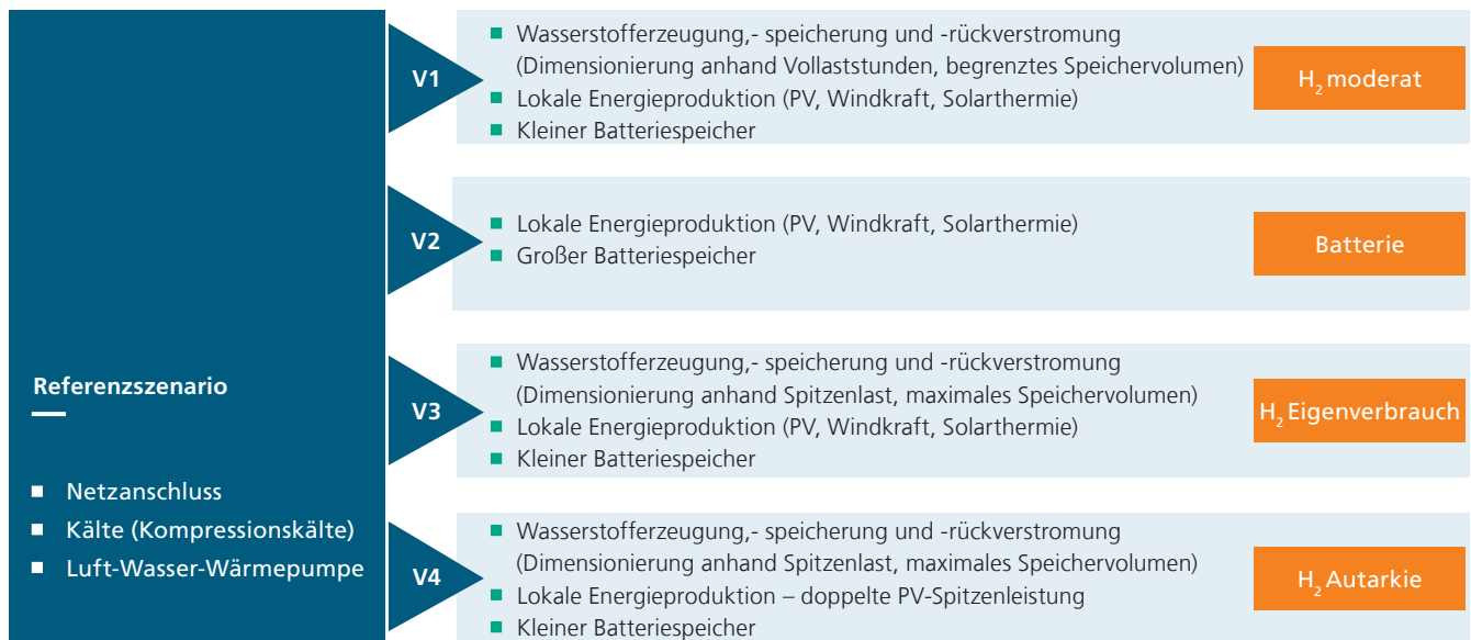
Abbildung 3: Simulierte Varianten – Varianten eines Speicherkonzepts für ein autarkes Energiesystem
