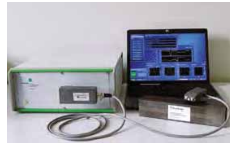
Figur 2: 3MA-II-Prüfsystem (PC, Steuergerät, Prüfkopf auf Bauteil liegend)
