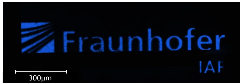
Abbildung 4.59: Mikroskopaufnahme der Elektrolumineszenz einer LED, die durch Laserbearbeitung mit der L µ B hergestellt wurde. Die Emissionswellenlänge liegt bei 400 nm.
