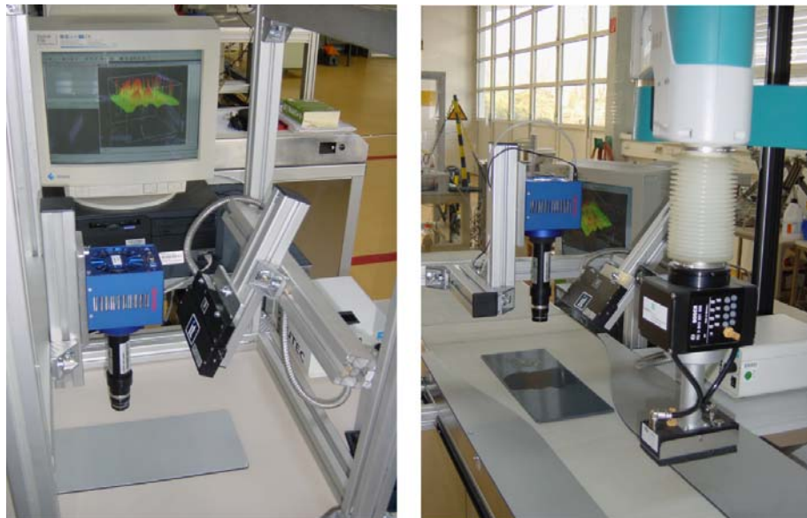
Bild 5.7: Versuchsaufbau zur Prozessintegration der orts aufgelösten NIR-Spektroskopie
