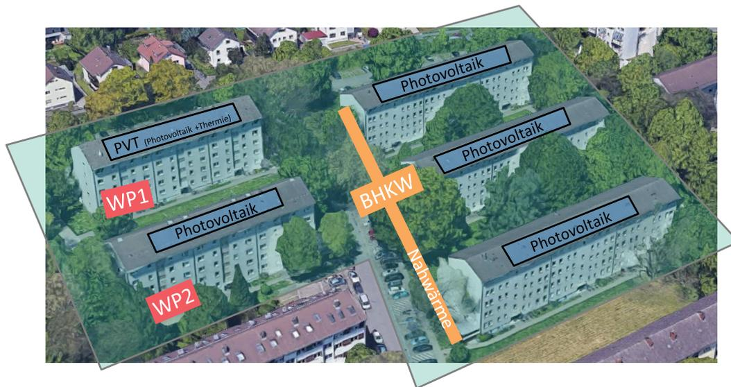
**Bild 1: Neues Energiekonzept des „Smarten Quartier Durlach“ mit Photovoltaik, zwei Wärmepumpen und einem BHKW mit Nahwärmeleitung. Bildquelle: GoogleEarth.**
