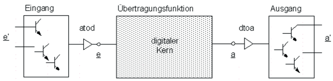
Abbildung 3.6: Struktur eines Mixed-Signal-Makromodells
