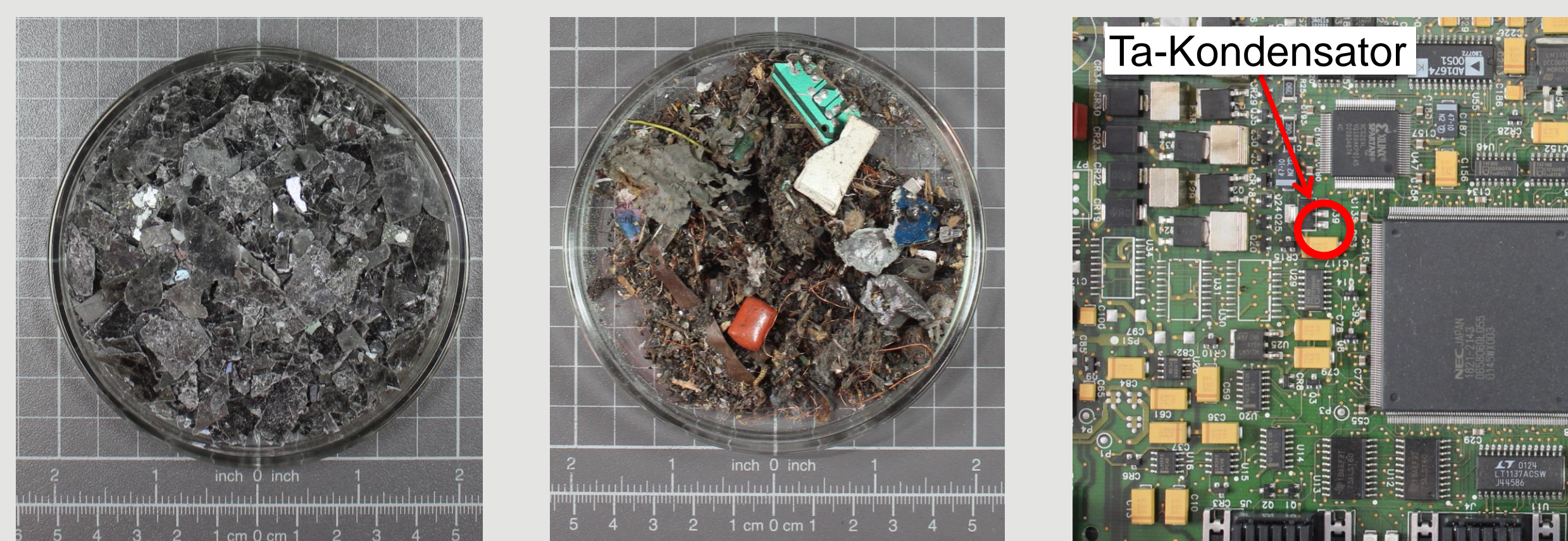
EAG-Fractionen: zerkleinerte LCD, EAG-Aufbereitungsrückstand, Leiterplatte mit Ta-Kondensatoren
