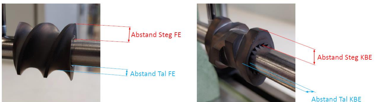
Abbildung 3.4: Messprinzip der Fördererelemente und Knetblöcke
