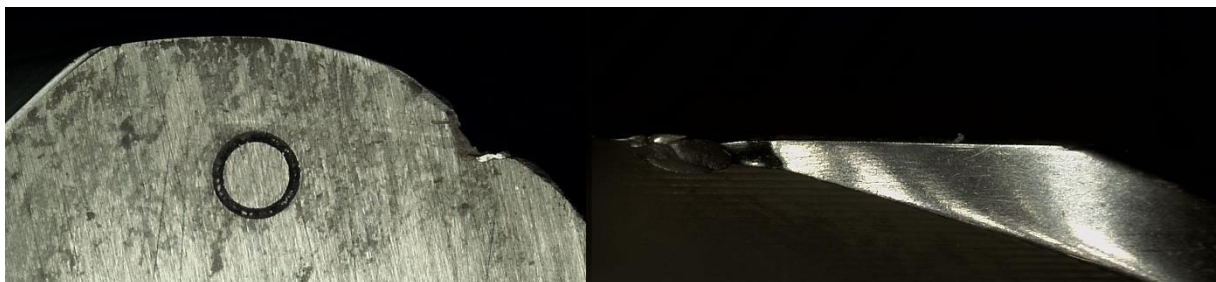
Abbildung 6.2: Ausbruch- FE Saramet26, von vorne (links) & von oben (rechts)
