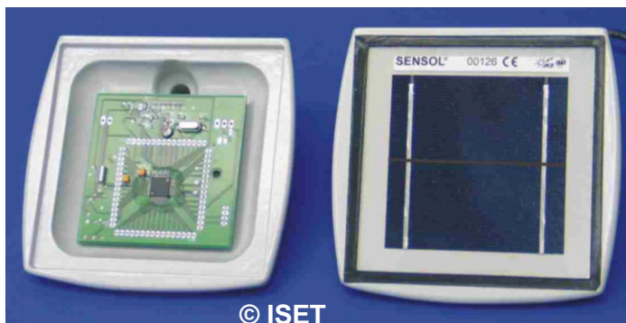
Bild 2 SMD-Platine (links), SENSOL ® power (rechts)
