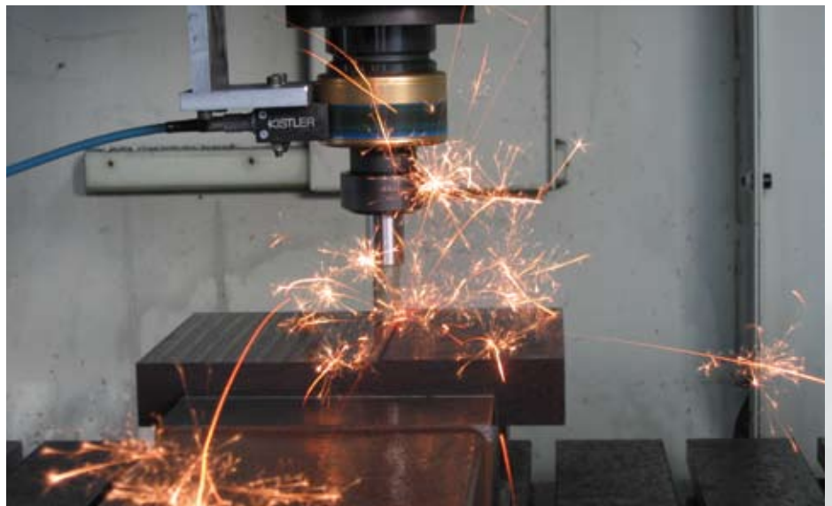
Prototypisches Keramikfräswerkzeug bei der Bearbeitung eines hochwarmfesten Stahls
