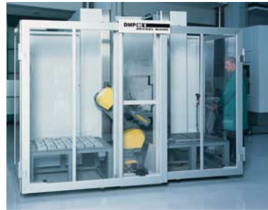
Makrolonplatten als Maschinenschutz
