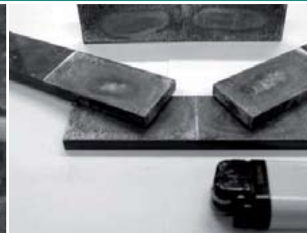
Thermisch induzierte Reaktion zum Fügen mittels organisch umhüllten Nanopartikeln (oben) sowie Fügezonenaufnahmen und gefügte Teile nach Zugversuch (unten)
