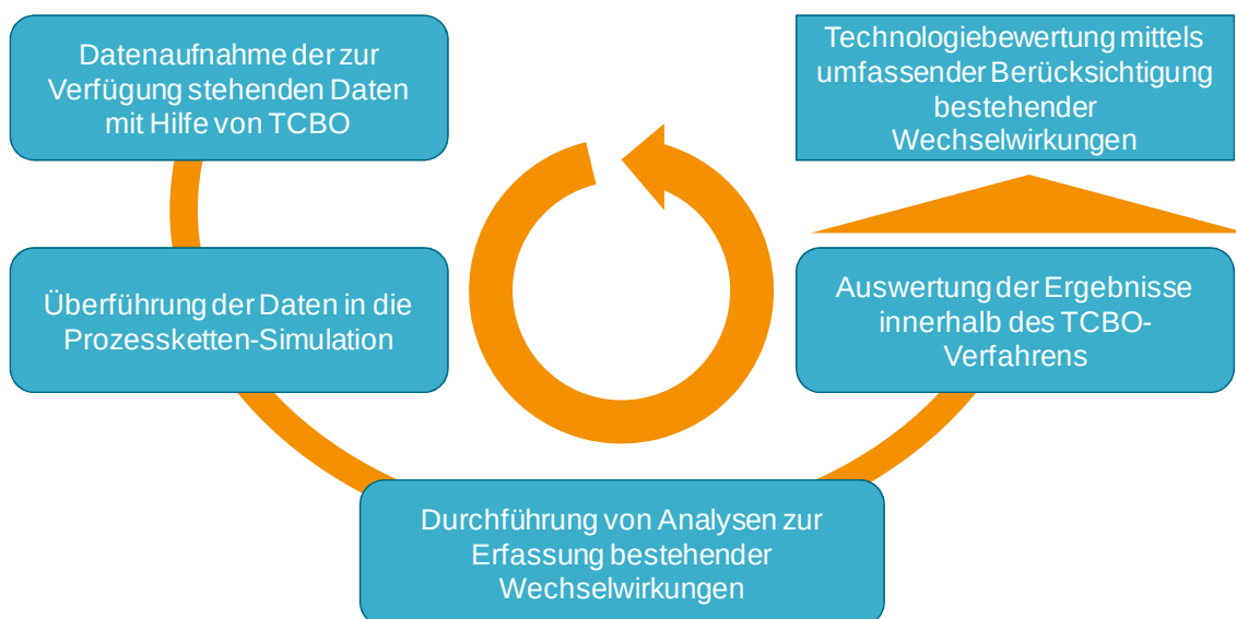
Abbildung 9: TCBO-Bewertung mittels Prozesskettensimulation
