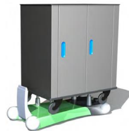
Containertransport im Krankenhaus
