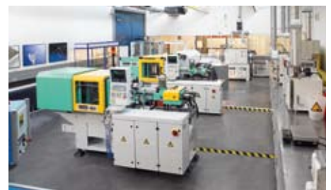
Um den gesamten Ablauf der Pulververarbeitung – von der Mischung über die Aufbereitung, dem Spritzgießen bis hin zum Entbindern und Sintern der Spritzteile – auch testen und vorführen zu können, verfügt ARBURG über ein bestens ausgestattetes PIM-Labor. Darüber hinaus wurde auch im neuen Kundencenter ein spezieller PIM-Bereich eingerichtet. Foto: ARBURG GmbH + Co KG
