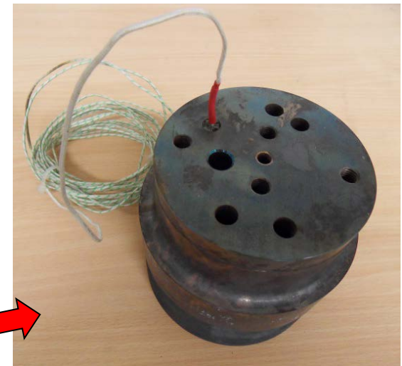
Werkzeugstempel mit integriertem Thermoelement
