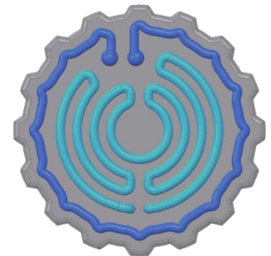
generativ gefertigter Stempel (CAD Modell)
