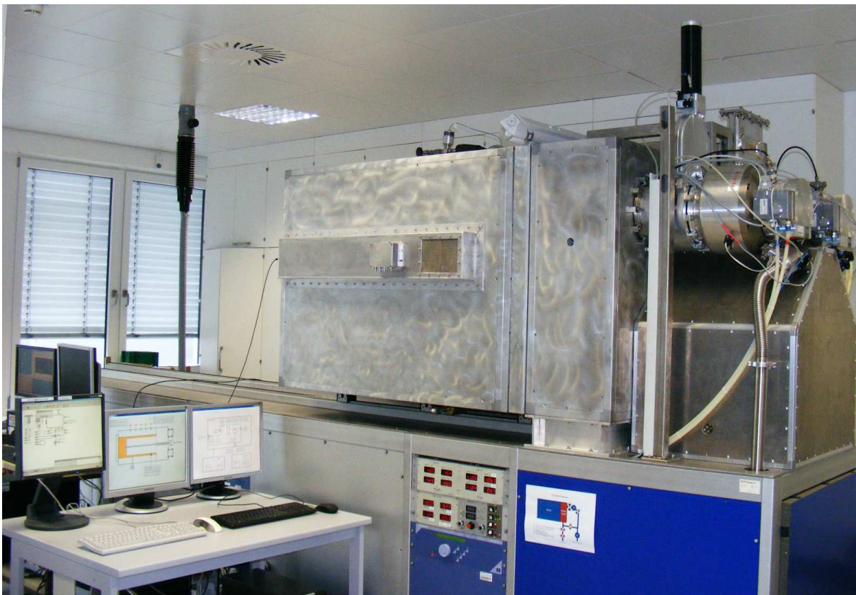
Abb. 4.4.: Betrieb des Prozessmonitors an der Beschichtungsanlage.
