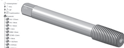
Abbildung 2: parametergesteuerte Konstruktion des Furchenwerkzeuges
