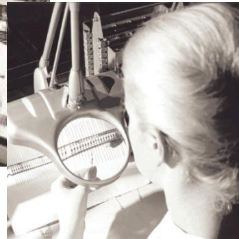
Manuelle Montage von Dioden und Transistoren bei Telefonen im Jahr 1950
