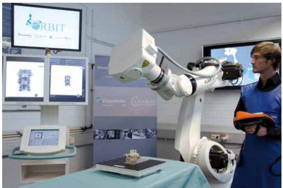
Prototyp des offenen 3D-Röntgenscanners ORBIT am Fraunhofer IPK (Bild: Fraunhofer IPK)
