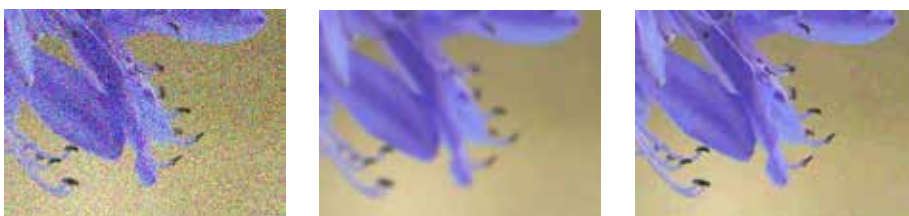
Erste Bewertung eines Bildes durch Kennzahlen zu Rauschen, Unschärfe und Blockbildung
