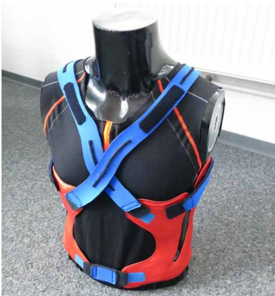
Konstruktionsprinzip der softrobotischen Oberkörperweste »CareJack«
