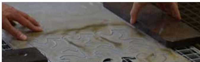
Ein starker Wasserstrahl schneidet aus Metall Berliner Bären zum Mitnehmen.
