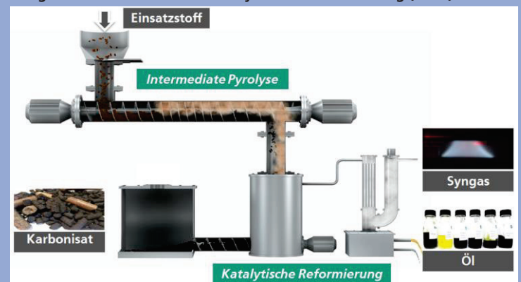
Anlagenschema der Thermo-Katalytischen Reformierung (TCR ® )
