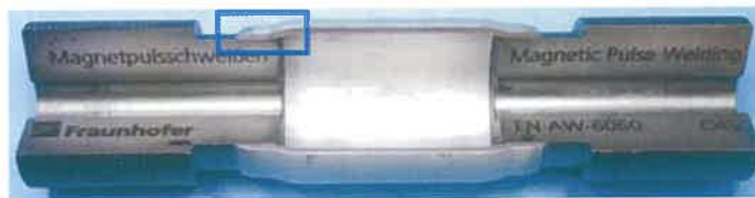
Mit Zwischenschicht (5 μm Nickel)
