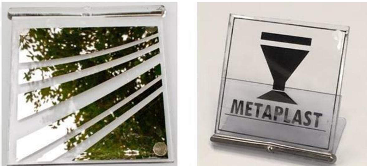
Abbildung 17. Lokal vernickelte Polymersubstrate nach lokaler Pd-Bekeimung mittels Arc-PVD.
