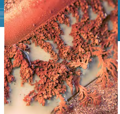
Die bei der ECM entstehenden Dendriten können zu Kurzschlüssen führen. © Fraunhofer IISB
