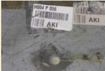
RFID-Transponder im Boden eingelassen
