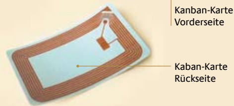
RFID-Kanban-Karte mit integriertem RFID-Transponder
