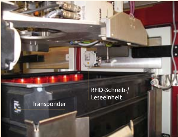
Vollautomatisches Lager für Kalotten in Montagelinie
