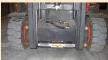
RFID-Antenne am Gabelstapler montiert
