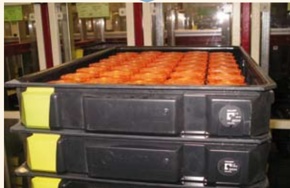
Gefülltes Tray mit Kunststoffkalotten (Identifikation über Transponder)
