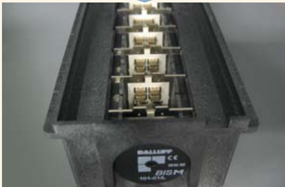
Gefülltes Tray mit Elektronik (Identifikation über Transponder)
