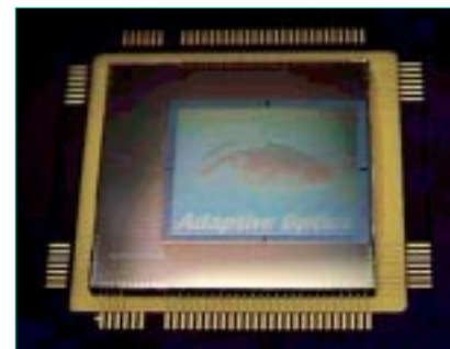
Lichtmodulator für die Wellenfrontkorrektur (200 x 240 Pixel) Light modulator for wave front correction (200 x 240 pixel)
